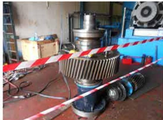
*Prise d'une turbine et d'un multiplicateur de vitesse hors service*
